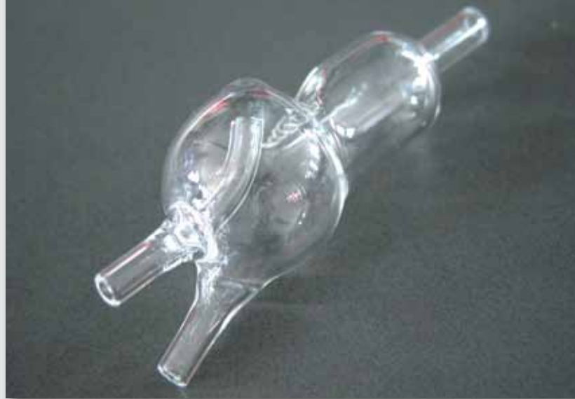
▲ Gas- und Flüssigkeits-Separator
